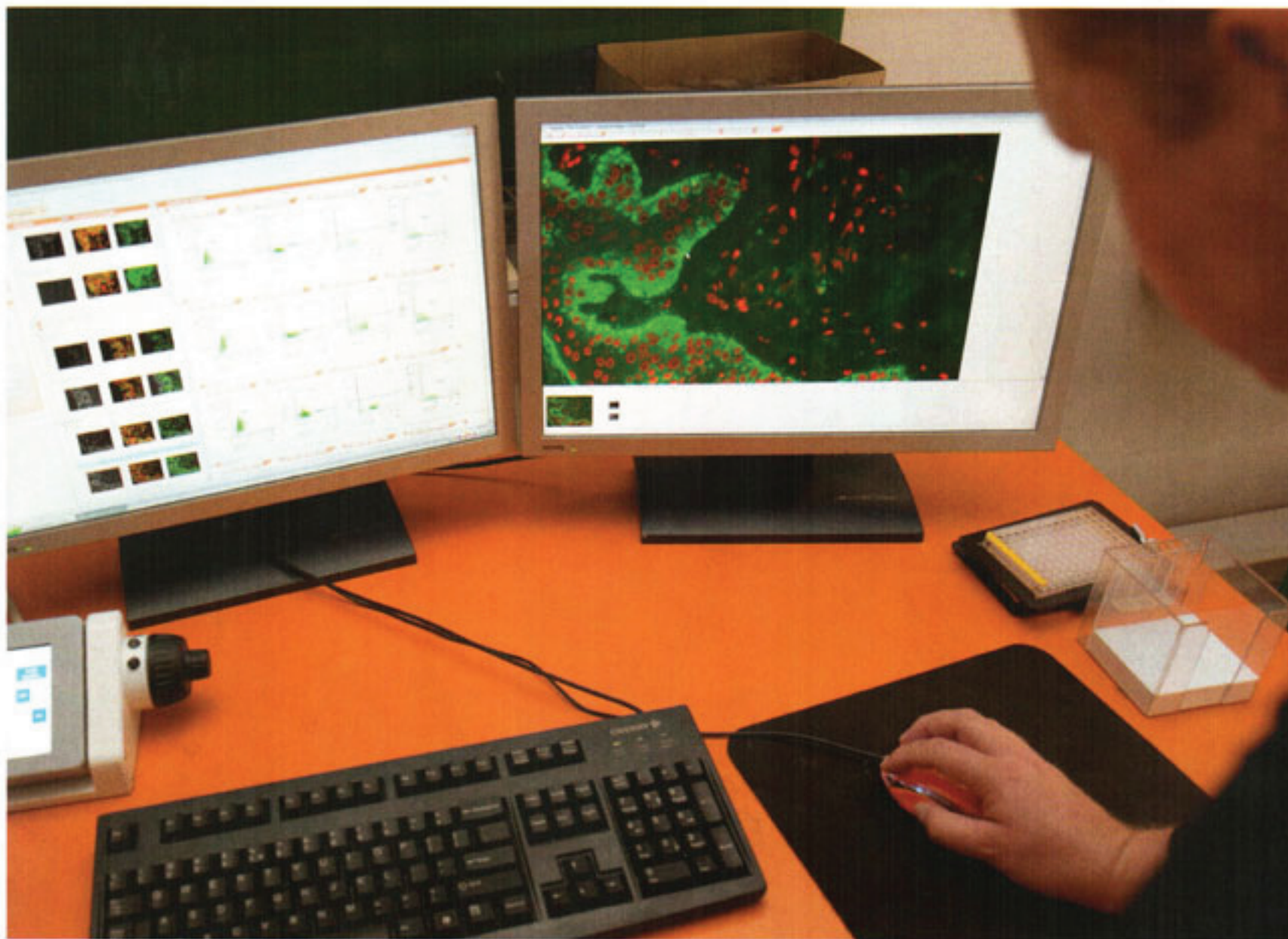
Fluoreszenzaufnahmen (rechter Bildschirm) werden in Daten umgewandelt und als Streudiagramme (linker Bildschirm) wiedergegeben.
